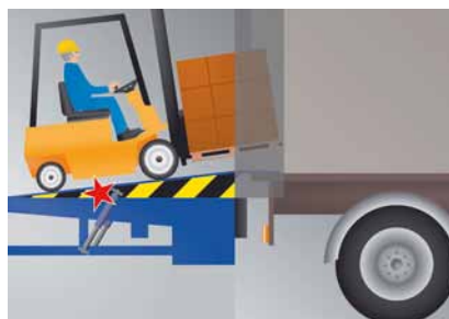
Safeguard noodstop met twee cilinders.
