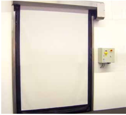
Brama szybkobieźna Crawford 9210 HY Do zastosowań specjalnych, na przykład w przemyśle spożywczym, gdzie wymagane jest utrzymanie wysokiego poziomu higieny. Kompletna ościeżnica* wykonana jest ze stali nierdzewnej. Maks. rozmiar (W×H): 4000×4000 mm Prędkość działania: Otwieranie: do 1.2 m/s Zamykanie: 0.5 m/s
