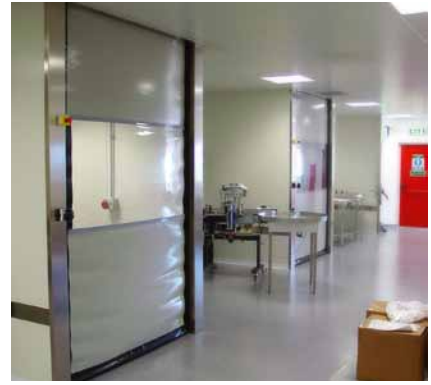
Brama szybkobieźna Crawford 9210 AT Brama hermetyczna do pomieszczeń czystych wewnątrz budynku. Maks. rozmiar (W×H): 4000×4000 mm Prędkość działania: Otwieranie: 1.2 m/s Zamykanie: 0.5 m/s
