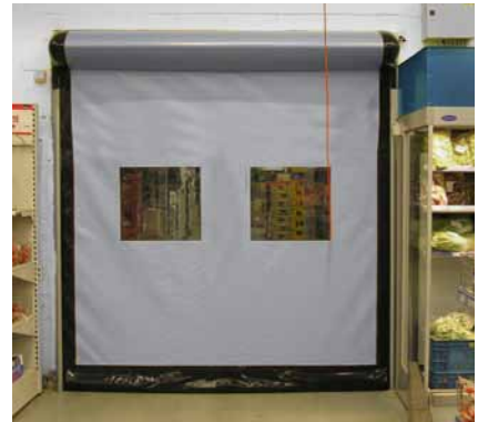
Crawford 9220 HY snabbrullport För specialtillämpningar som livsmedelsbranschen där kraven på hygien är höga. Det kompletta ramverket* är tillverkat i rostfritt stål. Detta är den mest utrymme-effektiva snabbrullportmodellen. Max storlek (b×h): 3500×3500 mm Drifhastighet: Öppning: upp till 2.7 m/s Stängning: 0.5 m/s
